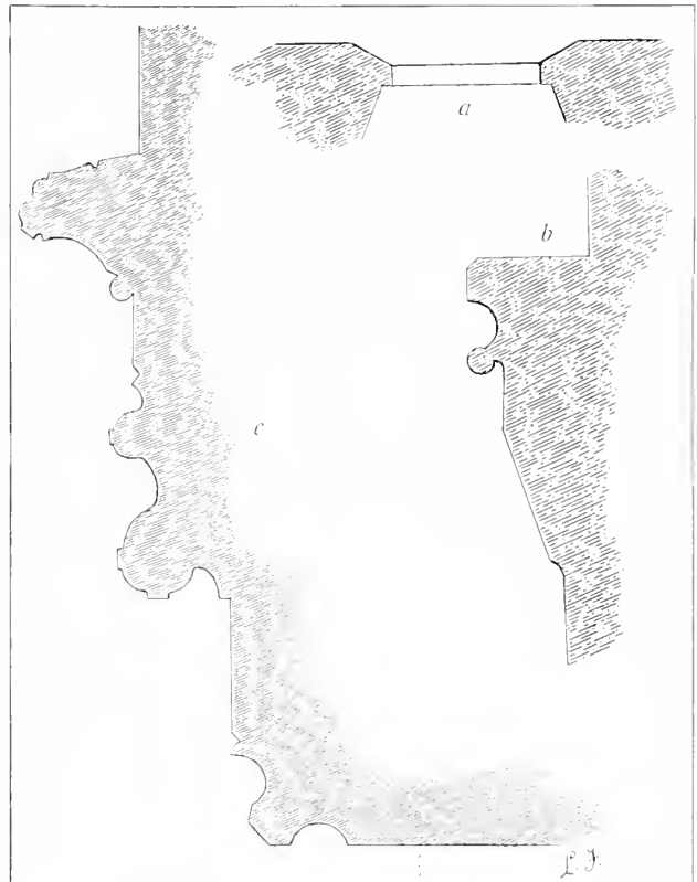
Fig. 17. - MESSINA - Chiesa di S. Maria alla Scala. a) Sezione orizzontale dello squarcio delle finestre laterali esterne. - b) Sezione della mensola delle volte a crociera. - c) Profilo dell'archivolta della porta sul fianco settentrionale della chiesa.
